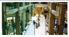
Bei Farbkameras wird die Farbe des beobachteten Objekts von der Farbtemperatur der Ausleuchtung (z.B. bei Leuchtstoffröhren) bestimmt. Ein automatischer Weißabgleich kann auf wechselnde Lichtverhältnisse (z.B. Wechsel zwischen Tageslicht und Kunstlicht) reagieren und die Farbe des Bildes entsprechend abgleichen.
